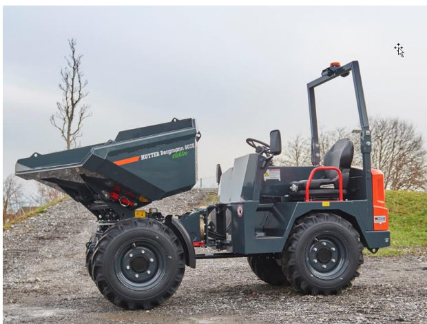
Bildunterschrift: Der Elektro-Raddumper 802E von Bergmann hat eine Nutzlast von 1'500 kg.
